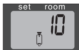
K: Quando appare la spia FUEL, verranno mostrati i minuti di funzionamento che ancora rimangono alla stufa in base alla quantità di combustibile rimasta nel serbatoio.
