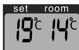
G: Vaadittu lämpötila vasemmalla, mitattu lämpötila oikealla.
