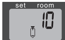
K: Når drivstoffindikatoren lyser, viser informasjonsdisplayet hvor mange minutter ovnen kan brenne før beholderen er tom.
