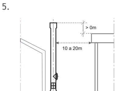
O terminal deve elevar-se acima de qualquer construção situada num raio entre 10 a 20m de distância à saída da chaminé.
