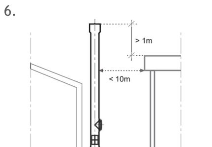
O terminal deve elevar-se pelo menos 1m acima de qualquer construção situada num raio inferior a 10m de distância à saída da chaminé.
