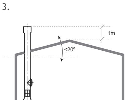
Quando a cobertura é plana ou com inclinação inferior a  $20^\circ$ , o terminal deve colocar-se pelo menos 1m acima do topo da mesma.
