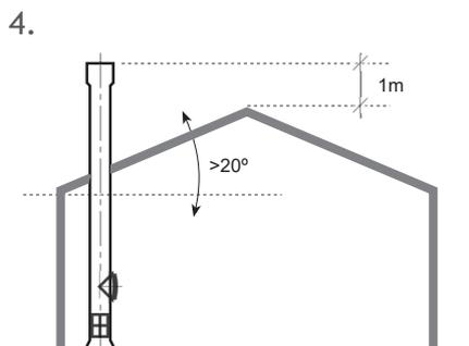
Quando a cobertura tem inclinação superior a  $20^\circ$ , o terminal deve colocar-se pelo menos 1m acima do topo da mesma ou a uma distância horizontal superior a 2,5m.
