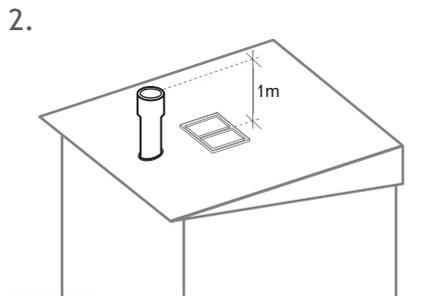
O terminal deve elevar-se pelo menos 1m acima do ponto mais elevado de qualquer abertura de ventilação ou janela existente no edifício.
