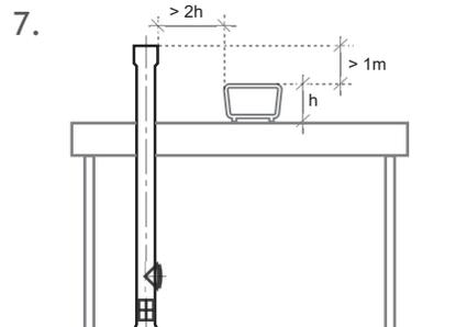
O terminal deve elevar-se o mínimo de 1m acima de qualquer obstáculo existente na cobertura do edifício e situar-se a uma distância superior a 2 vezes a altura do mesmo obstáculo.
